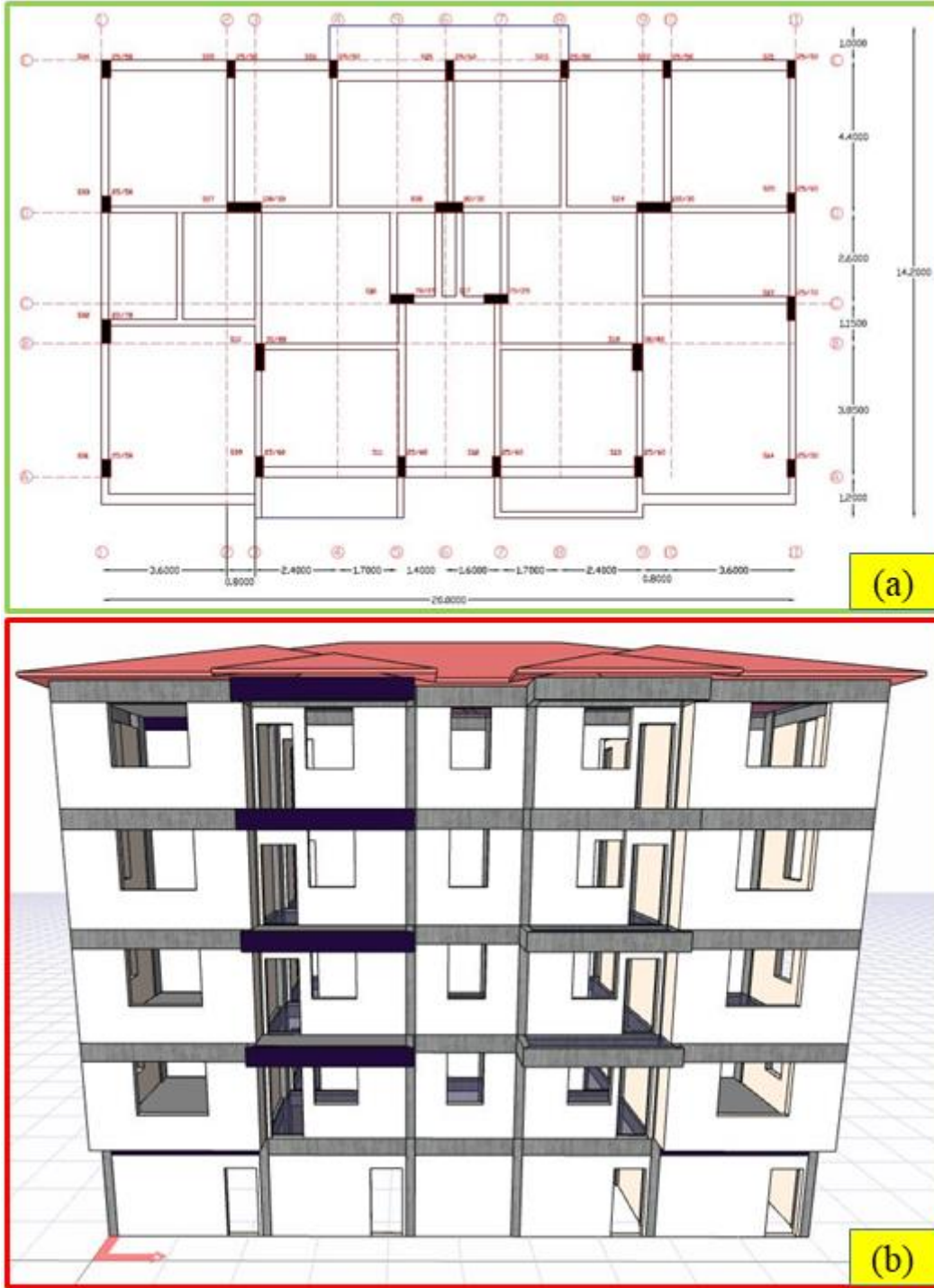
Şekil 2. Yaklaşık metraj hesabında dikkate alınan tipik bina: (a) Kalıp planı, (b) 3 boyutlu görseli.
