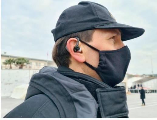
Şekil 40.1 Kulakta Kalp Atımını Ölçen Sensör 13
